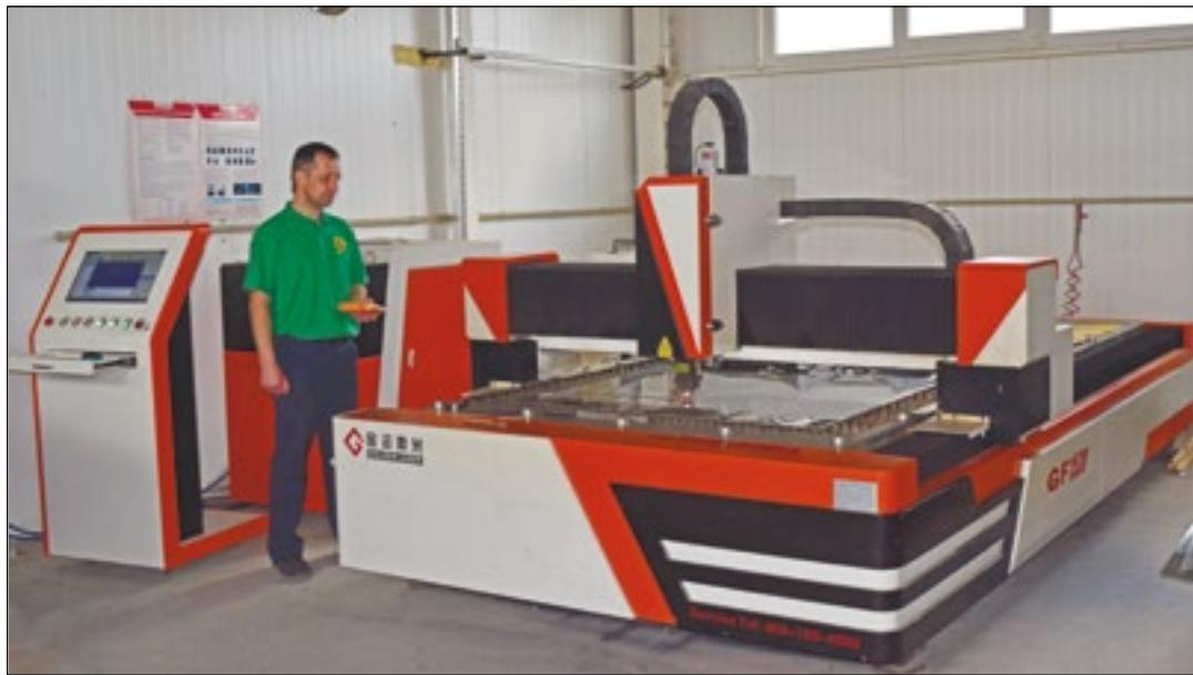
*За волоконно-лазерною машиною GF-1530 з ЧПУ
