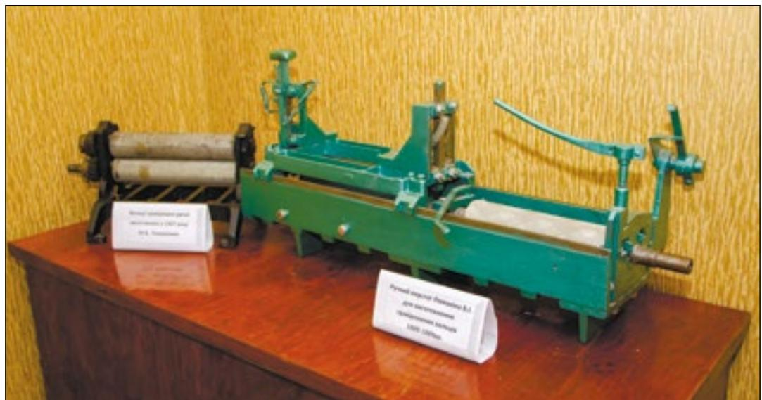
Ручний верстат для виробництва гравірованих вальців конструкції В.І. Ломакіна
